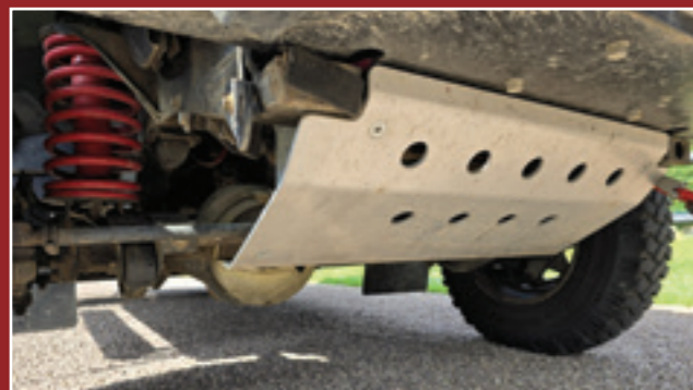
Un blindage avant protège le bas-moteur.
