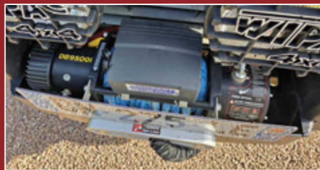
Le treuil Britpart DB 9500 I d'une puissance de 4 T.
